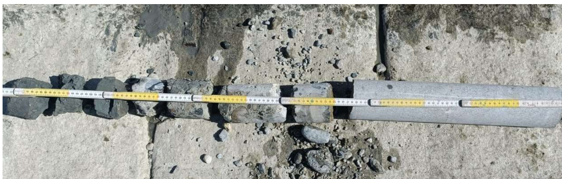
Figura 8: Carota n. 3 con terreno sabbioso argilloso
